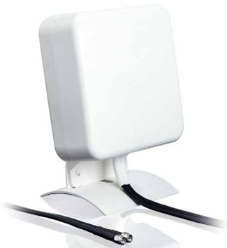
Die MIMO-Technik („Multiple In Multiple Out“) dieser Antenne sowie zwei Ultrabreitbandempfänger verstärken das gesamte Frequenzspektrum der LTE- und UMTS-Signale in allen in der EU üblichen Frequenzbändern bis zu einem Gewinn von 2 mal 2,5 dBi. Die Wand- oder Mastmontage ist einfach, das Gehäuse wettergeschützt. Die Antenne wird an ein LTE- oder zwei UMTS/HSPA+-Module von Viprinet angeschlossen.
