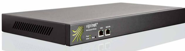
Mit einer Bündelungskapazität von bis zu 200 MBit/s ist dieser Hub für die Einrichtung kleiner und mittlerer Unternehmensnetzwerke geeignet. Eine Versorgung von
