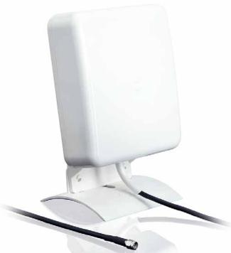
UMTS-Signale sind in Gebäuden häufig schlecht. Dagegen hilft diese Außenantenne. In deren wetterfesten Gehäuse befindet sich ein Ultra-Breitbandempfänger, der einen Gewinn von bis zu 11 dBi erzielt. Die Antenne ist für die Wand- und Mastmontage geeignet und muss auf den Sendemast des jeweiligen Mobilfunkproviders ausgerichtet werden.
